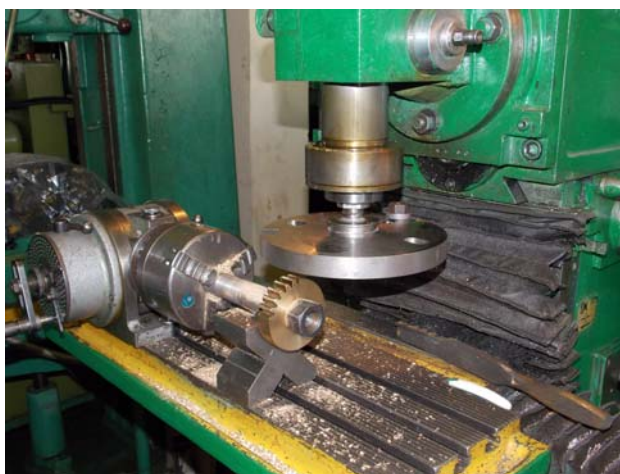
Рисунок 2 – Процес нарізання та виготовлене арчне зубчасте колесо
