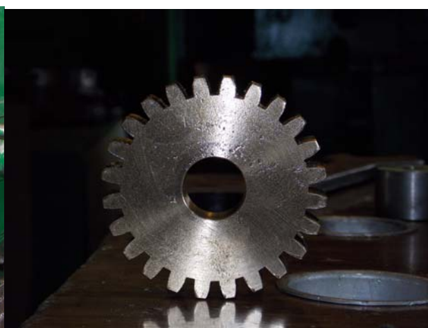
Рисунок 2 – Процес нарізання та виготовлене арчне зубчасте колесо
