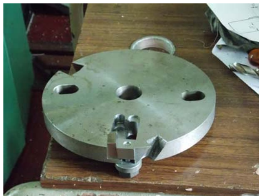
Рисунок 1 – Торцева різцева головка з регульованим розташуванням різця
