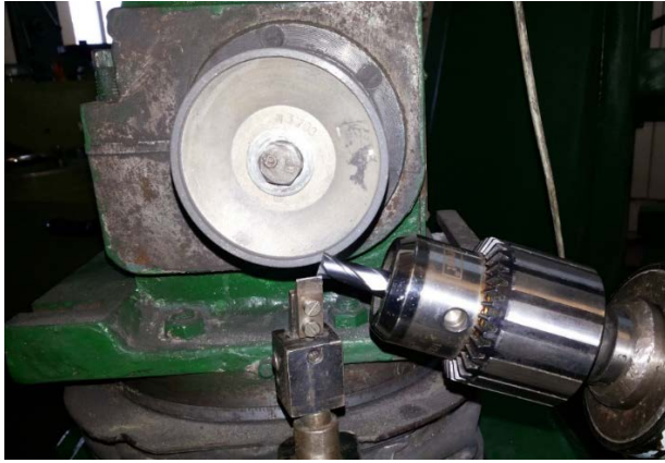
Рис. 3. Заточка фрези по передній поверхні
