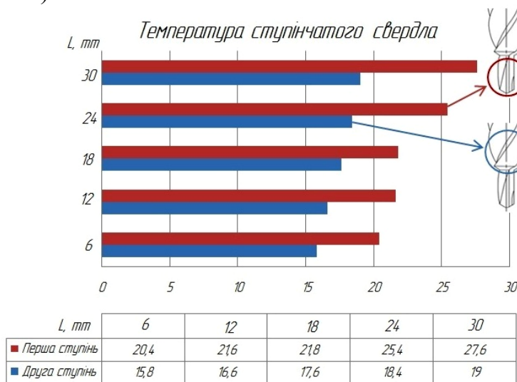
Рис. 4 Температура ступінчатого свердла
