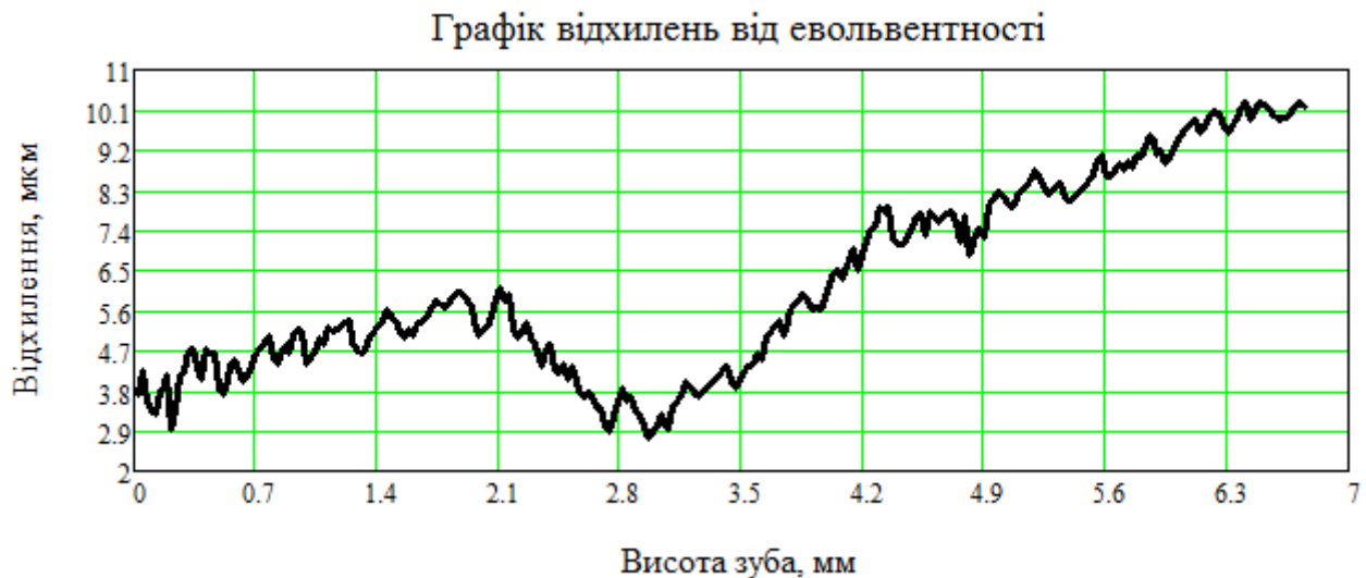
Рисунок 2 – Значення відхилень по висоті зуба в нульовому перерізі
