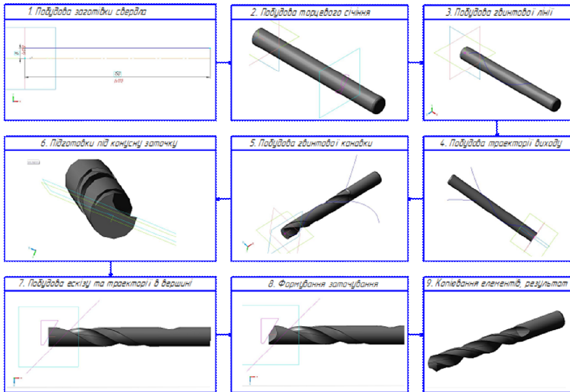
Рисунок 3 – Автоматизована побудова моделі свердла
